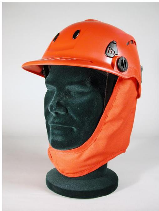
Sahariana avvolgente per la protezione della nuca e del collo, rimovibile e lavabile, realizzata in tessuto ignifugo 100% aramidico da 185 gr/mq., foderata con tessuto ignifugo 100% modacrilico da 200 gr/mq., applicabile alla calotta del casco Picchio con sistema a velcro.
